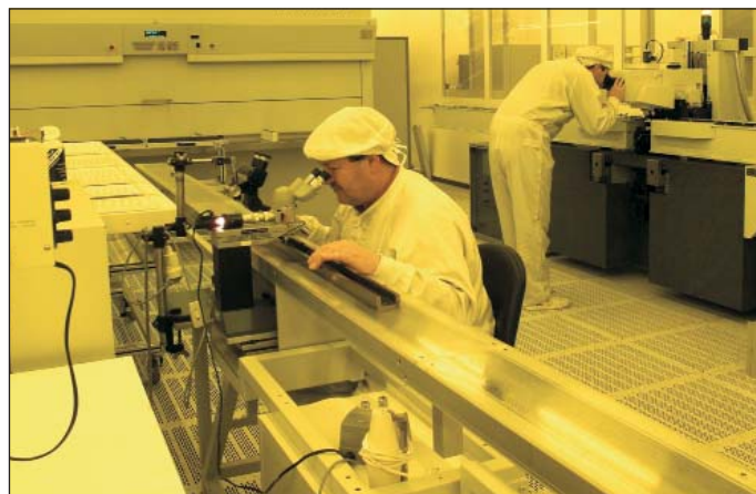
光刻室中的直线光栅尺检查
